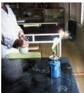
Coloración verde de la llama por la presencia de Cobre
