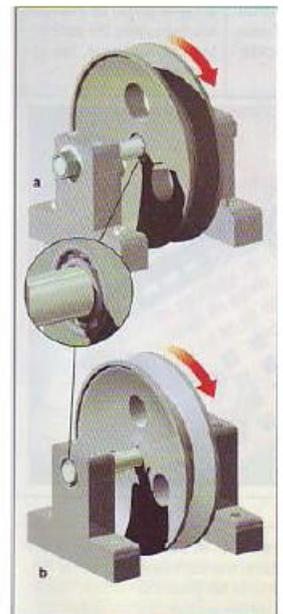
Fig. 2. Tipos de ejes: a) fijo; b) giratorio.
