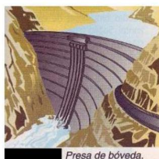
Todo dique debe permitir el escape del exceso de agua para evitar accidentes. El excedente de agua se puede eliminar a través de un aliviadero (por debajo de la cima de la presa), mediante un pozo de desagüe (interior del embalse) o por un túnel de desagüe (bordeando el dique).
