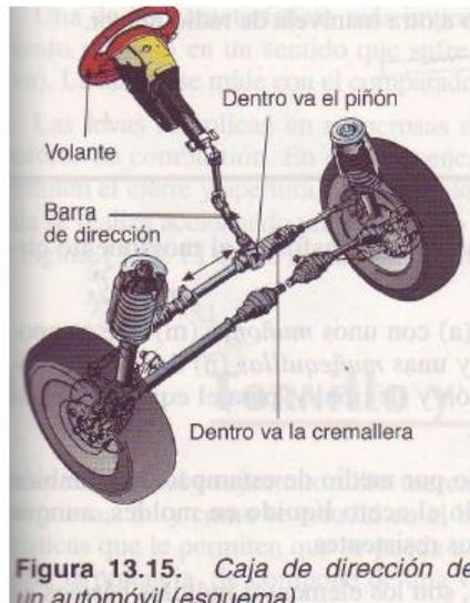
Figura 13.15. Caja de dirección de un automóvil (esquema).
