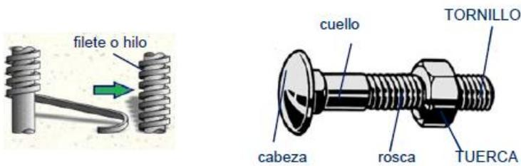
Es la operación que permite realizar una **hélice, hilo o filete**, sobre un cilindro, para obtener un tornillo o tuerca.
