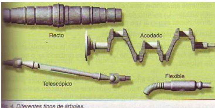
Un **árbol** es un *elemento de una máquina, cilíndrico o no, sobre el que se montan diferentes piezas mecánicas*, por ejemplo, un conjunto de engranajes o poleas, a los que se transmite potencia. Pueden adoptar diferentes formas (rectos, acodados, flexibles,...). Los arboles (también llamados **árboles de**
