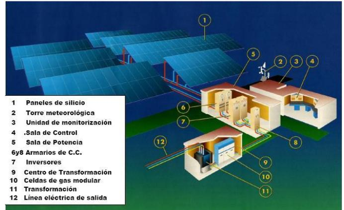
*Grandes centrales:* generación masiva de electricidad, solo posible en condiciones favorables de evolución de la tecnología fotovoltaica, el coste de las fuentes energéticas convencionales y las condiciones climáticas
