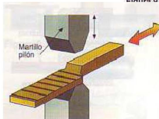
Actualmente se emplean **prensas**, accionadas mecánicas o hidráulicas, que comprimen el material hasta darle la forma deseada. También se emplean **martillos mecánicos** que golpean el material sucesivamente. Los materiales que admiten forja son
