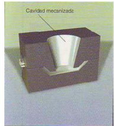
Fig. 4. Molde permanente o coquilla.
