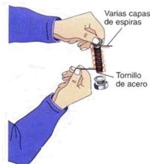
Si enrollamos un cable alrededor de un hierro (un tornillo, varillas,...) tendremos una bobina mucho más potente ya que el hierro facilita la circulación del campo magnético por el interior de la bobina. Este diseño se denomina electroimán y tiene múltiples aplicaciones, timbres, grúa industrial, ...
