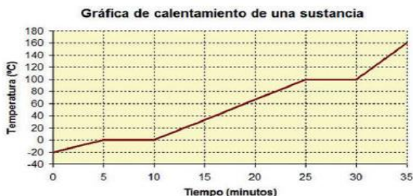
Imagen 19. Gráfica T-t Aumento de temperatura y temperatura constante en los cambios de estado.
