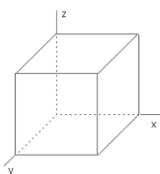
Un cubo de lado 0.3 m está colocado con un vértice en el origen de coordenadas como se muestra en la figura. Se encuentra en el seno de un campo eléctrico no uniforme, que viene dado por  $\mathbf{E} = (-5x \mathbf{i} + 3z \mathbf{k}) \text{ N/C}$
