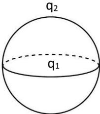
El teorema de Gauss dice que el flujo del campo eléctrico  $\phi$  que atraviesa una superficie cerrada es igual a la carga  $Q$  contenida dentro de dicha superficie dividida por la permitividad dieléctrica del medio  $\epsilon$ .
