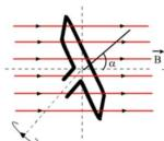
En la figura de la derecha se ve una espira que gira con velocidad angular constante en el seno de un campo magnético. El flujo que atraviesa la espira variará en función del ángulo que forme con el campo magnético. Si suponemos que para t =0 la espira está perpendicular al campo ( **11 =** 0):
