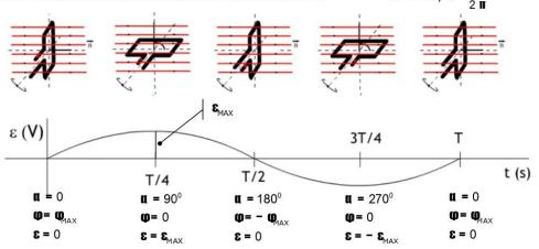
La intensidad que circula por la espira se puede calcular si aplicamos la ley de Ohm generalizada al circuito Si suponemos que la resistencia es R:
