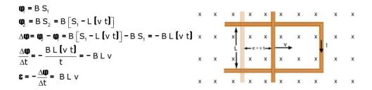
Aplicando la ley de Ohm generalizada podemos obtener la intensidad que circula. Suponiendo que la resistencia del circuito es R:
