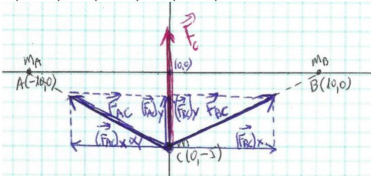
Hallamos los módulos de  $r_{AC}$  (distancia entre A y C) y de  $r_{BC}$  (distancia entre B y C) que son iguales
