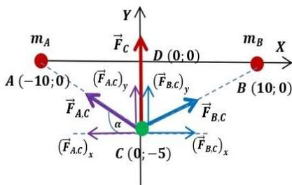
Dibujamos los ejes y situamos las masas. Después dibujamos las fuerzas vectoriales que actúan sobre la masa del punto C, debida a la atracción de  $m_A$  y  $m_B$ . Recuerda que las fuerzas salen de  $m$  (2 kg) y van hacia  $m_A$  y  $m_B$
