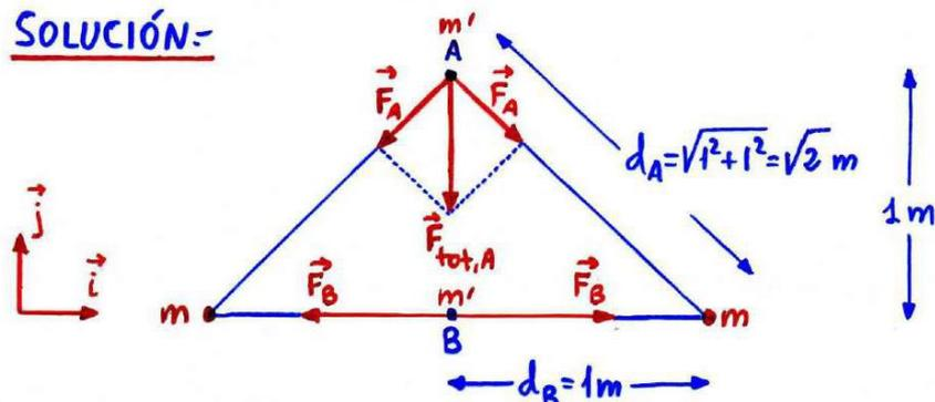
Aplicando las leyes de gravitación universal y fundamental de la Dinámica, obtenemos las siguientes fuerzas y aceleraciones:
